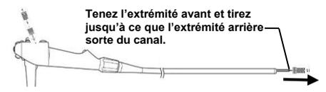
Figure 9. Nettoyage des canaux d'aspiration et de l'instrument
